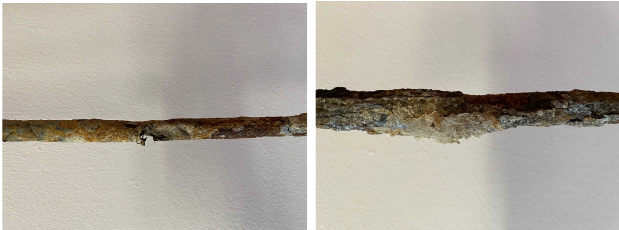
Detailní ukázka vyjmutého potrubí a 100% poškození korozí z venkovní strany, na jeho částech jsou patrné zbytky betonu.
